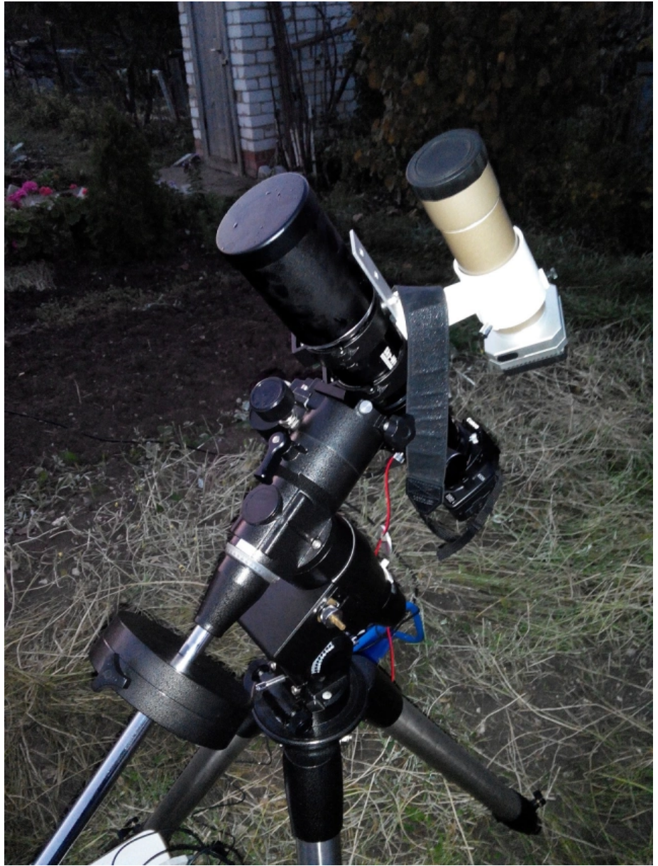
SW 66 ED Equinox с редьюсером-флеттнером WO 0,7 Type III на монтировке CG5. Гид — SW 8×50+QH-Y-6
